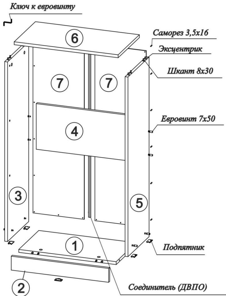
Рисунок 1 – Сборка каркаса
