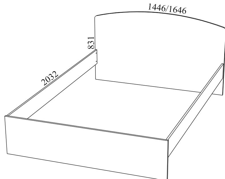
Габаритные размеры: ширина - 1446/1646 мм, высота - 831 мм, глубина - 2032 мм.
