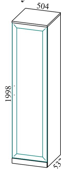
Габаритные размеры: ширина - 504 мм, высота - 1998 мм, глубина - 532 мм.
