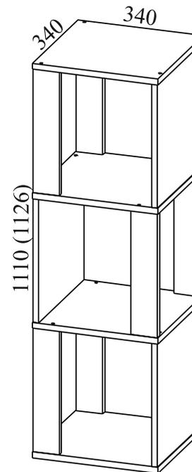
Габаритные размеры: ширина - 340 мм, высота - 1110 (1126) мм, глубина - 340 мм.
