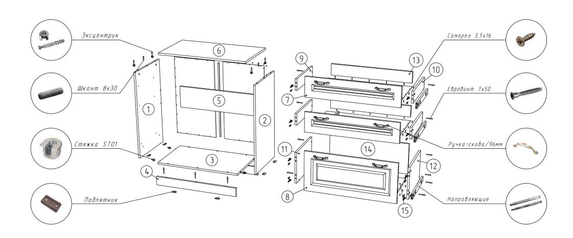
Рисунок 1 – Сборка каркаса
