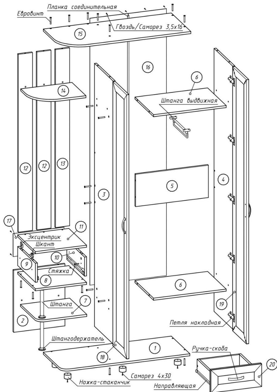
Рисунок 1 – Сборка каркаса
