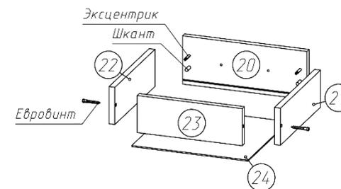
Рисунок 2 – Сборка ящика
