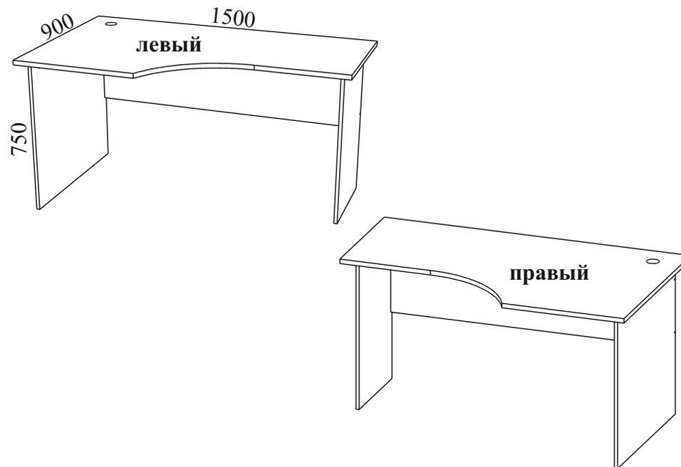
Габаритные размеры: длина - 1500 мм, высота - 750 мм, глубина - 900 мм.
