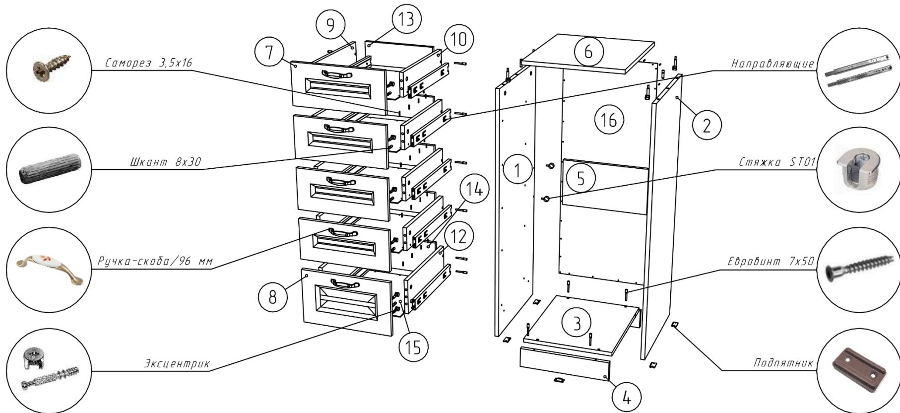
Рисунок 1 – Сборка каркаса
