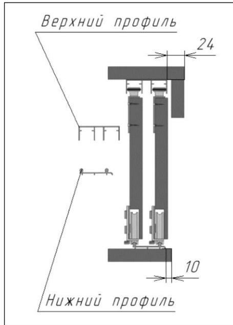
Рисунок 2 – Монтаж профилей и дверей купе, мм
