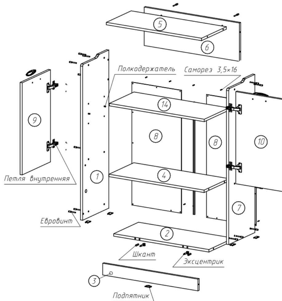
Рисунок 1 – Сборка каркаса
