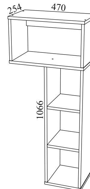
Габаритные размеры: ширина - 470 мм, высота - 1066 мм, глубина - 254 мм.
