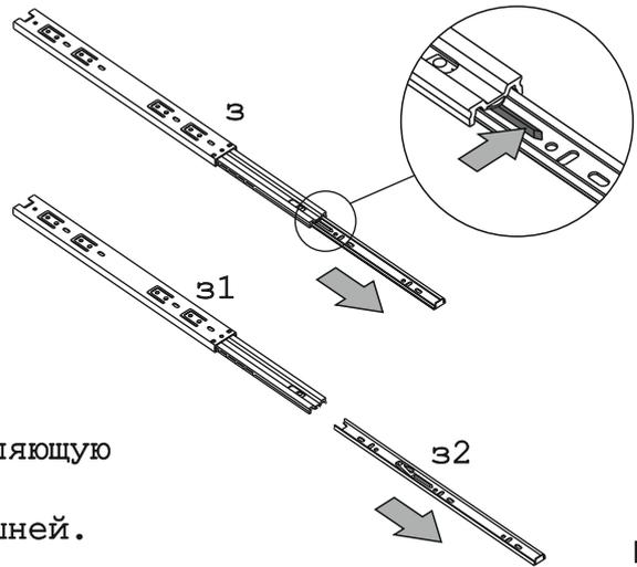
Перед началом сборки необходимо разъединить полновыкатные направляющие. Для этого максимально раздвинуть направляющую и нажать на пластиковый фиксатор. Далее выдвинуть внутреннюю часть из внешней.
