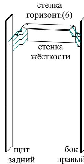
Стенка горизонтальная (6) и стенка жёсткости крепятся к щиту заднему и боку правому стяжками эксцентриковыми и шкантами.
