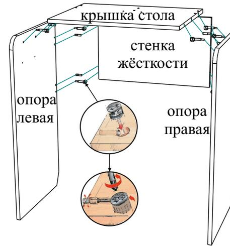
Опоры крепятся к стенке жёсткости и крышке стола шкантами и стяжками эксцентриковыми.
