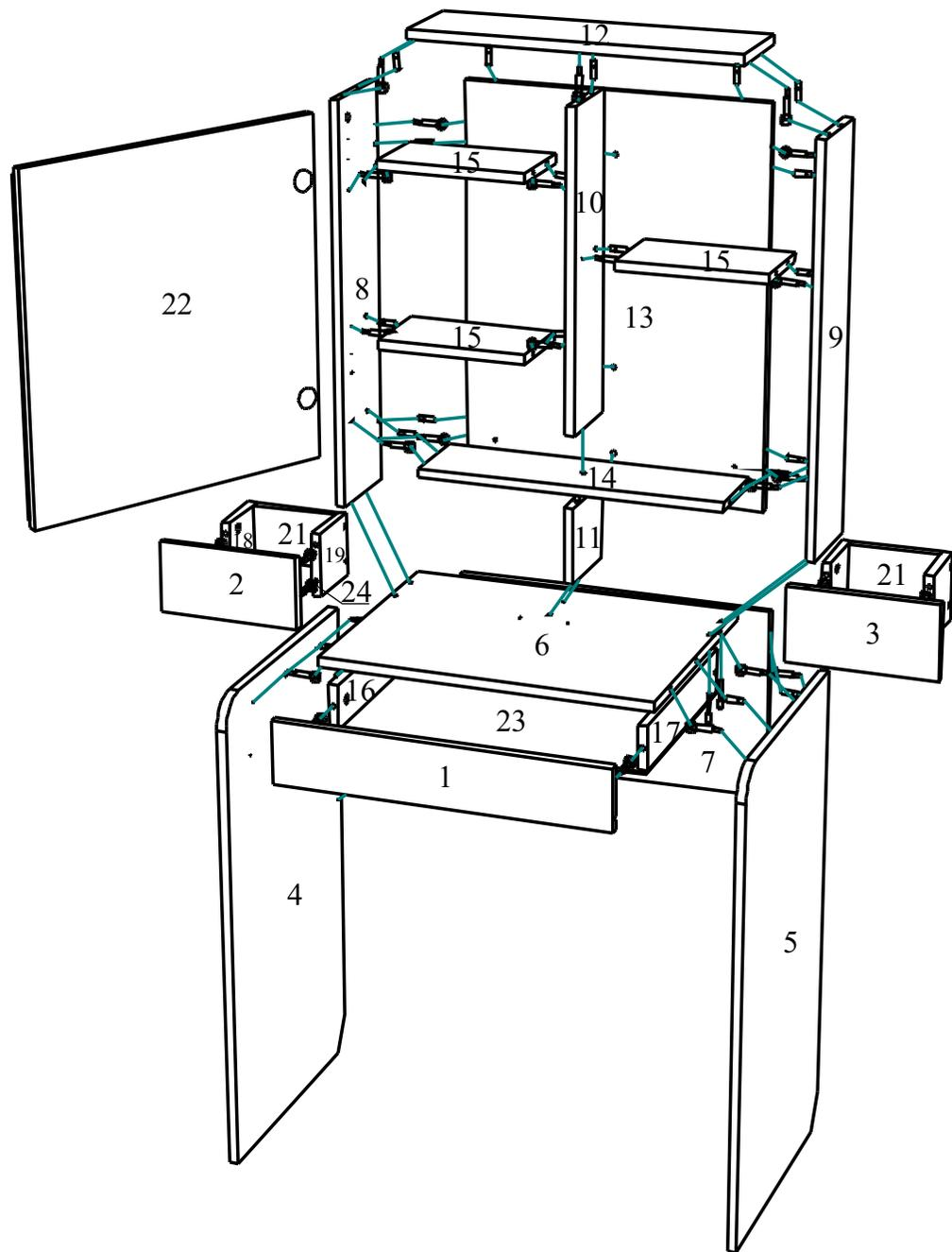
Полкодержатели крепятся к стенке задней (2 шт.) и в футорки на фасадах (2, 3) (по 2 шт.). Собранные конструкции соединяются евро-винтами, предварительно вставив малые ящики полкодержателями в крышку и стенку горизонтальную (14) через шайбы 05.
