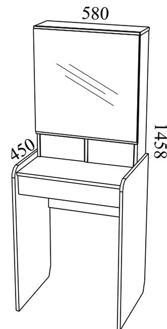
Габаритные размеры: длина - **580 мм**, высота - **1458 мм**, глубина - **450 мм**.
