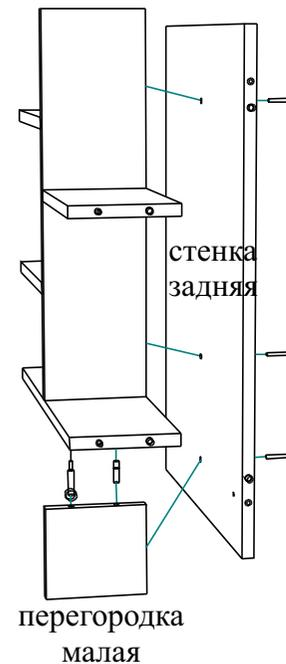
Перегородка малая крепится к стенке горизонтальной (14) шкантом и стяжкой эксцентриковой. Стенка задняя крепится к перегородкам еврвинтами.
