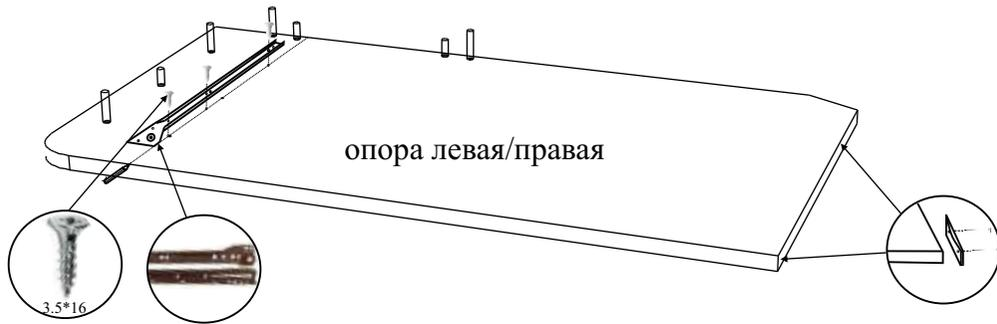
По наколкам на опорах проводятся горизонтальные осевые линии. Устанавливаются направляющие отверстиями на линии, отступая от края 1-2 мм. Крепятся направляющие саморезами 3.5\*16.
