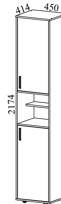
Габаритные размеры: длина - 450 мм, высота - 2174 мм, глубина - 414 мм.
