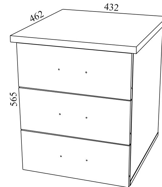
Габаритные размеры: длина - 432 мм, высота - 565 мм, глубина - 462 мм.
