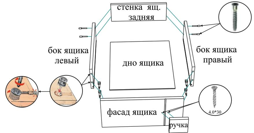
Бока ящика крепятся к стенке ящика задней евровинтами, фасад ящика - к бокам ящика стяжками эксцентриковыми. Дно ящика вставляется в пазы и крепится к стенке задней ящика саморезами 3.0\*20 через шайбы метал. с шагом примерно 100 мм. К фасаду и бокам ящика дно ящика крепится держателями задней стенки с саморезами 3.0\*20 по 2 шт. на сторону. Ручки крепятся к фасадам саморезами 4.0\*30 через шайбы пластмассовые.
