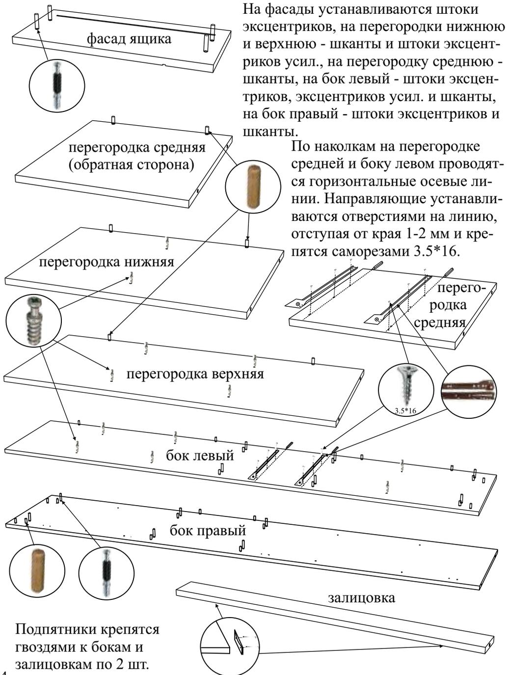
На фасады устанавливаются штоки эксцентриков, на перегородки нижнюю и верхнюю - шканты и штоки эксцентриков усил., на перегородку среднюю - шканты, на бок левый - штоки эксцентриков, эксцентриков усил. и шканты, на бок правый - штоки эксцентриков и шканты.
