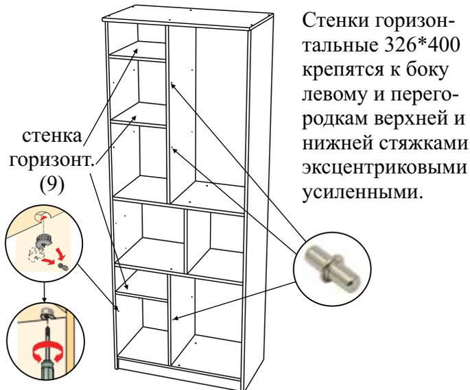
Стенки горизонтальные 326\*400 крепятся к боку левому и перегородкам верхней и нижней стяжками эксцентриковыми усиленными.
