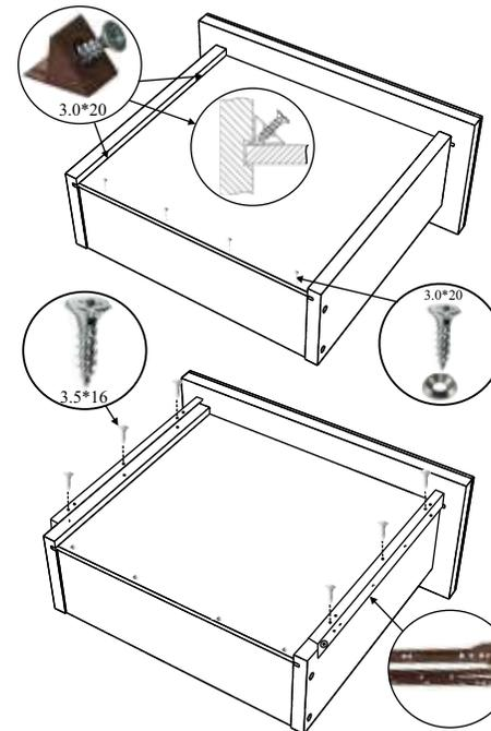
Ослабив саморезы, отрегулировать направляющие по высоте. После регулировки затянуть.
