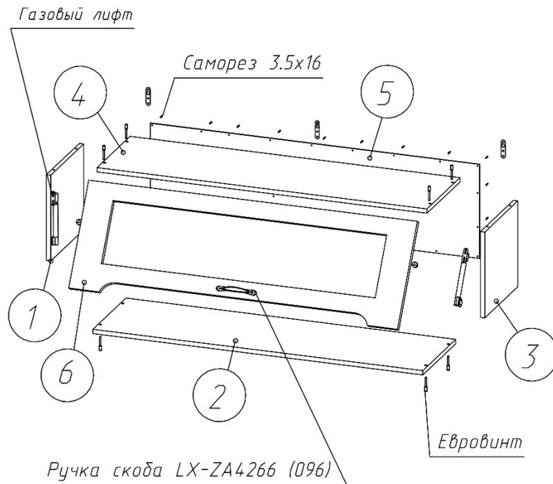
Рисунок 1 – Сборка каркаса
