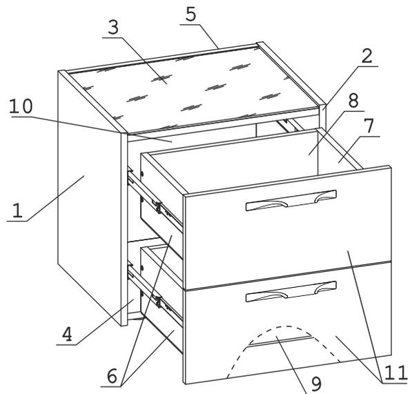
Перед началом сборки необходимо разъединить полновыкатные направляющие. Для этого максимально раздвинуть направляющую и нажать на пластиковый фиксатор. Далее выдвинуть внутреннюю часть из внешней.
