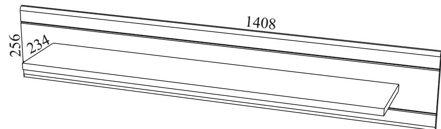
Габаритные размеры: длина - 1408 мм, высота - 256 мм, глубина - 234 мм.
