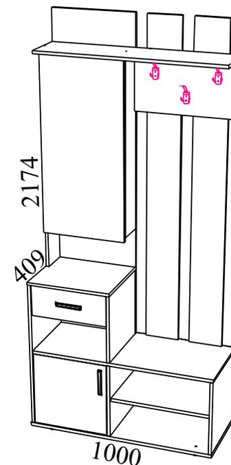
Габаритные размеры: длина - 1000 мм, высота - 2174 мм, глубина - 409 мм.
