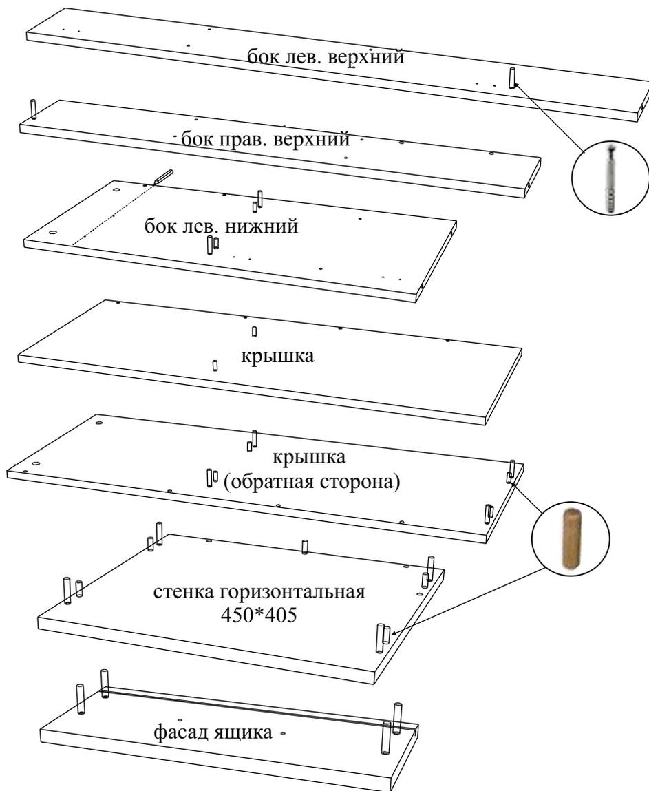
По наклкам на боку левом ниж., перегородке верх. и боках ящ. провести горизонтальные осевые линии. Установить направляющие отверстиями на линию, отступая от края 1-2 мм. Закрепить саморезами 3.5\*16.
