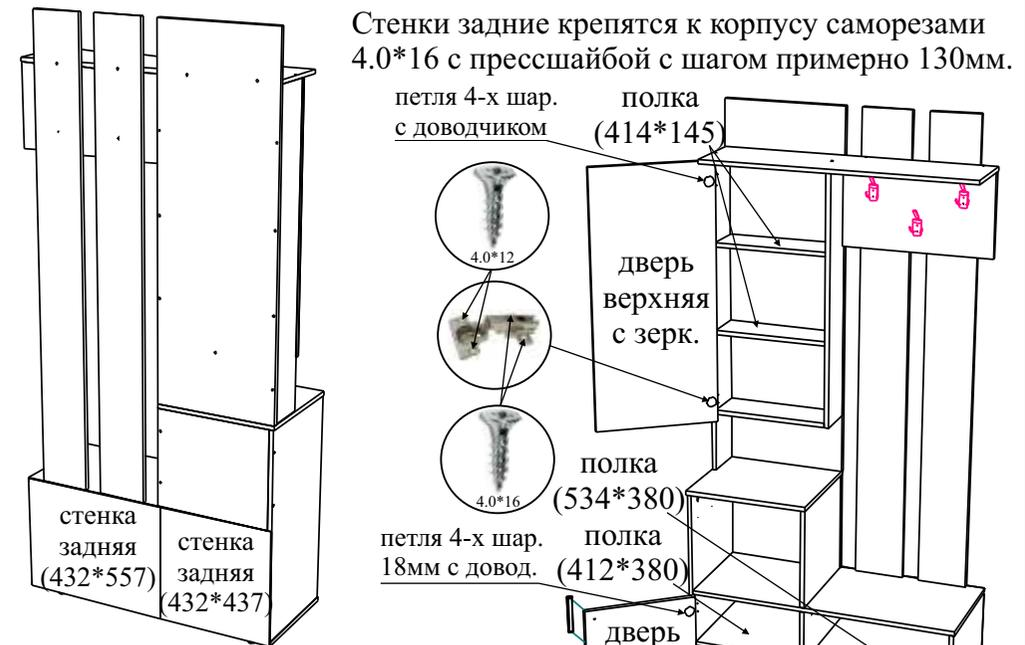
Петли 4-х шарн. крепятся к боку лев. верх., петли 4-х шарн. 18мм к боку лев. ниж. саморезами 4.0\*16, к двери верх. крепятся петли 4-х шарн, к двери ниж. - петли 4-х шарн. 18мм саморезами 4.0\*12. Крючки для одежды крепятся к стенке верт. (саморезы в комплекте), полки устанавливаются на полкодержатели.
