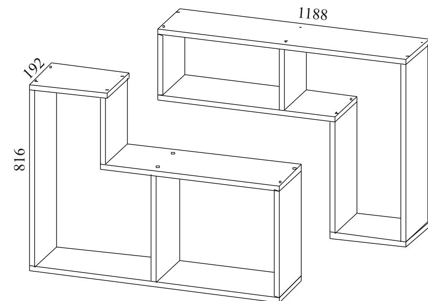
Габаритные размеры: длина - 1188 мм, высота - 816 мм, глубина - 192 мм.
