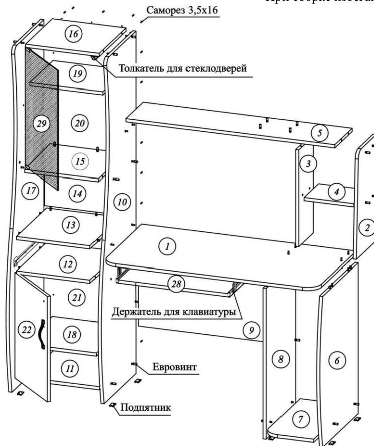
Рисунок 1 – Сборка каркаса
