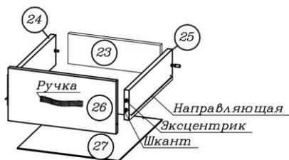
Рисунок 2 – Сборка ящика
