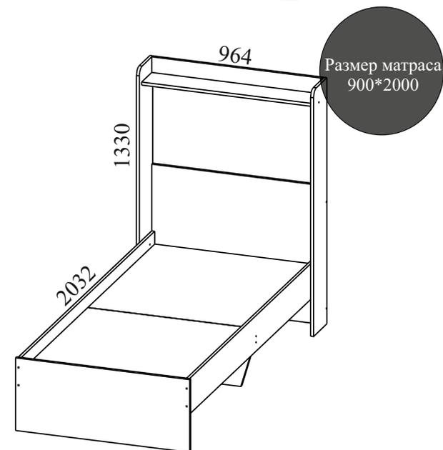
Габаритные размеры: ширина - 964 мм, высота - 1330 мм, глубина - 2032 мм.
