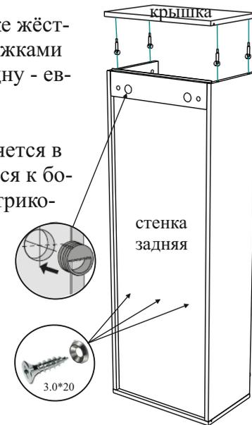
Стенки горизонтальные крепятся к бокам стяжками эксцентриковыми усиленными. Стенка задняя крепится к стенкам горизонтальным саморезами 3.0\*20 (по 3 шт.) через шайбы металлические.
