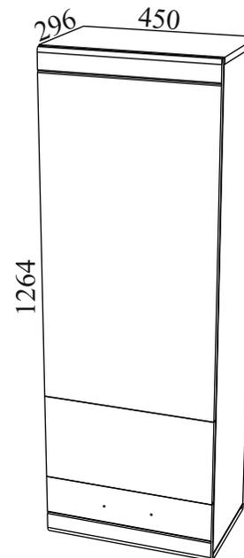
Габаритные размеры: длина - 450 мм, высота - 1264 мм, глубина - 296 мм.
