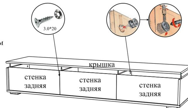
Стенка задняя ящика крепится к бокам ящика евровинтами, фасад ящика - стяжками эксцентриковыми. Дно ящика вставляется в пазы и крепится к стенке задней ящика саморезами 3.0\*20 (4 шт.) через шайбы металлические. Держатели задней стенки вставляются в пазы под дно ящика и крепятся саморезами 3.0\*20 (по 2 шт. на сторону). Ручки крепятся к фасадам ящиков через шайбы пластмассовые. Стяжками межсекционными тумба крепится к другим элементам гостиной.
