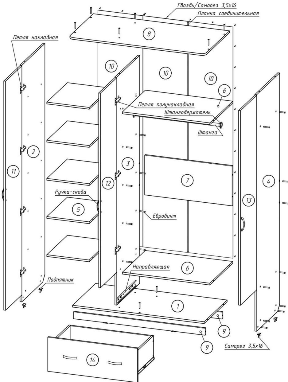
Рисунок 1 – Сборка каркаса
