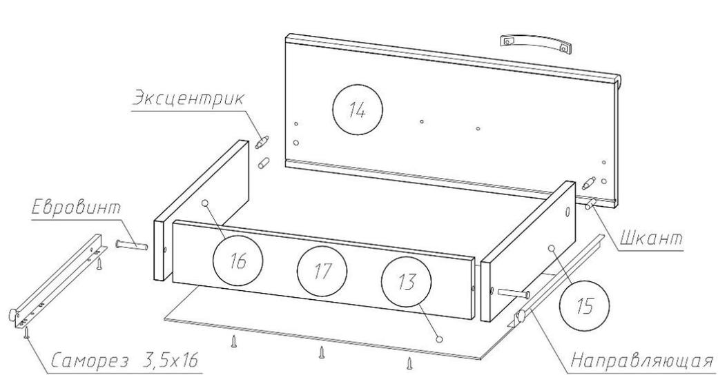
Рисунок 2 – Сборка ящика-1
