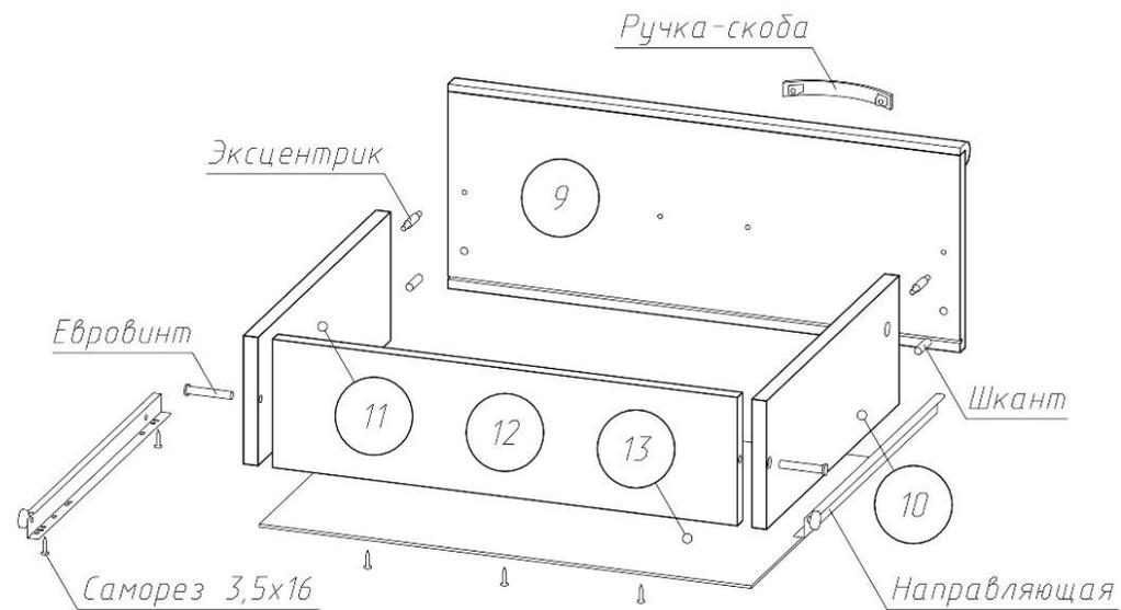
Рисунок 3 – Сборка ящика-2
