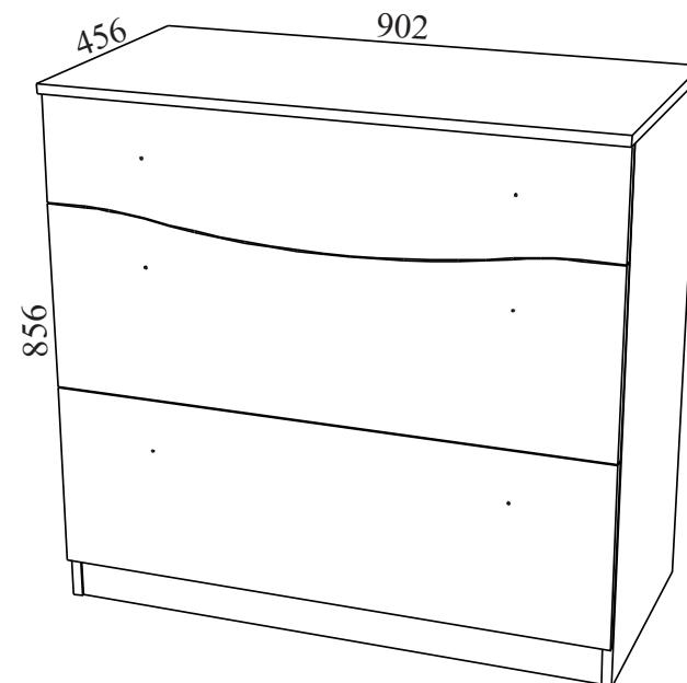
Габаритные размеры: длина - 902 мм, высота - 856 мм, глубина - 456 мм.
