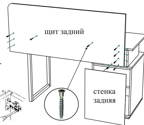
Щит задний крепится к крышке (5) (ширина стола зависит от места крепления), крышке (1) и стенке вертикальной евровинтами, к опоре - винтами 06\*25.
