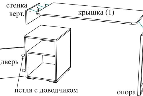
Крышка (1) крепится к стенке вертикальной стяжками эксцентриковыми, к опоре - винтами 06\*40.
