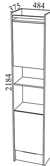
Габаритные размеры: ширина - 484 мм, высота - 2184 мм, глубина - 375 мм.
