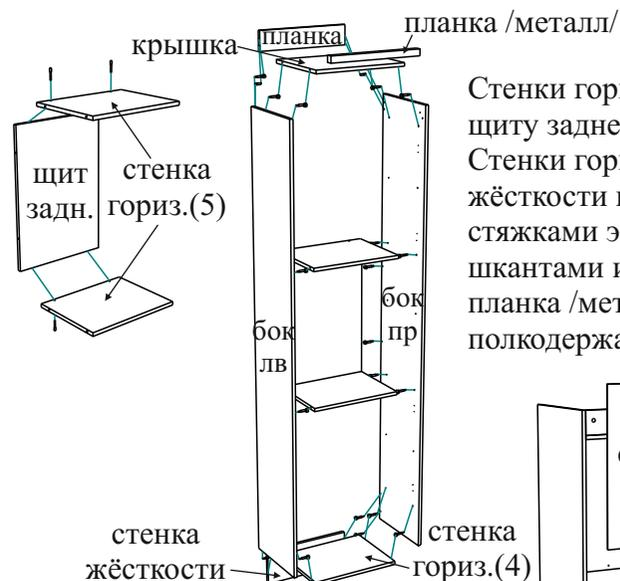
Стенки горизонтальные (5) крепятся к щиту заднему евровинтами. Стенки горизонтальные (4, 5), стенка жёсткости и крышка крепятся бокам стяжками эксцентриковыми, планка - шкантами и стяжками эксцентриковыми, планка /металл/ - устанавливается на полкодержатели.
