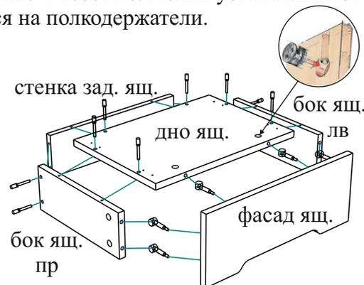
Бока ящика крепятся к стенке задней ящика евровинтами, к фасаду ящика - стяжками эксцентриковыми. Дно ящика крепится к фасаду ящ. стяжками эксцентриковыми, к бокам и стенке задней ящика - евровинтами.
