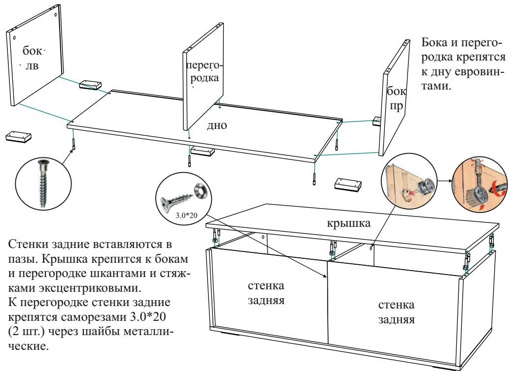
Стенки задние вставляются в пазы. Крышка крепится к бокам и перегородке шкантами и стяжками эксцентриковыми.
