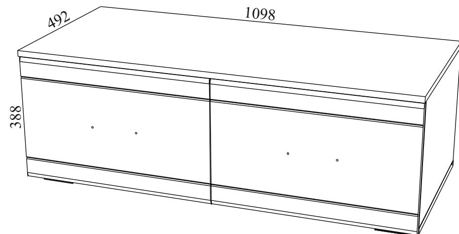
Габаритные размеры: длина - 1098 мм, высота - 388 мм, глубина - 492 мм.
