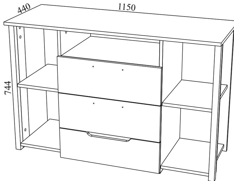
Габаритные размеры: ширина - 1150 мм, высота - 744 мм, глубина - 440 мм.
