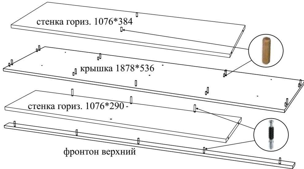
По наклкам на перегородках тумбы и боках ящ. проводятся горизонтальные осевые линии. Направляющие устанавливаются отверстиями на линию, отступая от края 1-2 мм, и крепятся саморезами 3.5\*16; присадочное отверстие считать первое от фасада. Направляющие разъединяются с помощью нажатия пластикового рычажка при вытягивании внутреннего полоза.
