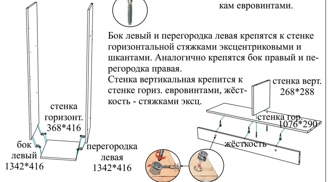
Бок левый и перегородка левая крепятся к стенке горизонтальной стяжками эксцентриковыми и шкантами. Аналогично крепятся бок правый и перегородка правая. Стенка вертикальная крепится к стенке гориз. евровинтами, жесткость - стяжками эксц.
