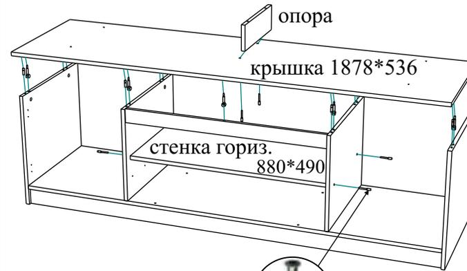
Опора крепится к крышке евровинтами. Крышка крепится к бокам и перегородкам тумбы стяжками эксц. и шкантами, к фронтому нижнему - стяжкой эксцентриковой. Стенка горизонтальная крепится к перегородкам евровинтами.
