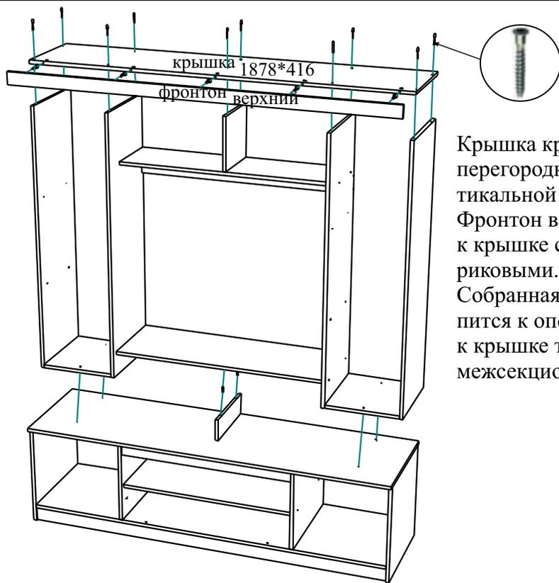
Крышка крепится к бокам, перегородкам и стенке вертикальной евроинтами. Фронтон верхний крепится к крышке стяжками эксцентровыми. Собранный конструкция крепится к опоре - шкантами, к крышке тумбы стяжками межсекционными.
