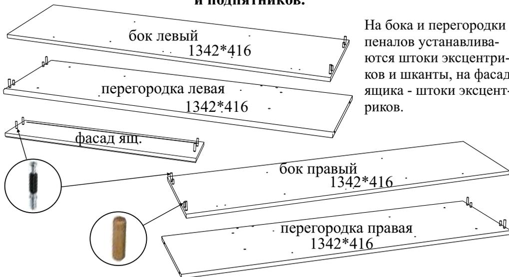
На бока и перегородки пеналов устанавливаются штоки эксцентриков и шканты, на фасад ящика - штоки эксцентриков.
