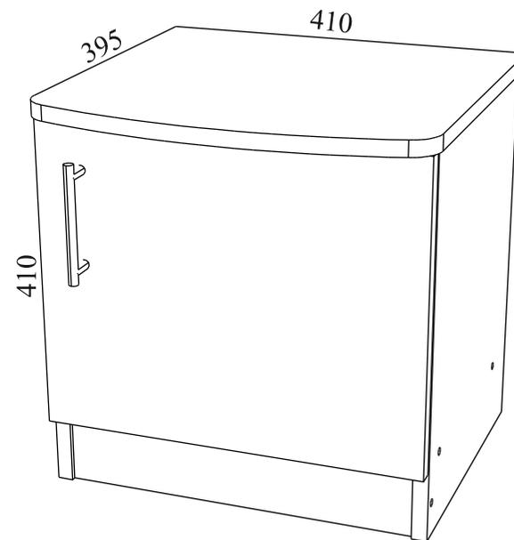
Габаритные размеры: ширина - 410 мм, высота - 410 мм, глубина - 395 мм.
