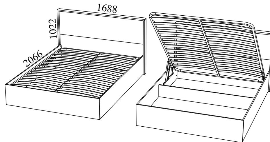
Габаритные размеры: длина - 1688 мм, высота - 1022 мм, глубина - 2066 мм.
