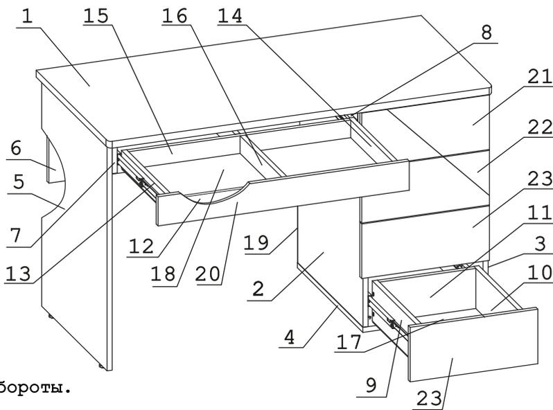
Перед началом сборки необходимо разъединить полновыкатные направляющие. Для этого максимально раздвинуть направляющую и нажать на пластиковый фиксатор. Далее выдвинуть внутреннюю часть из внешней.
