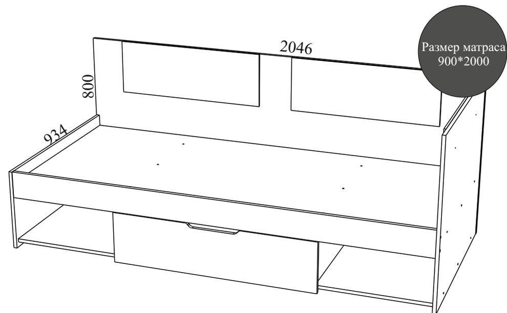
Габаритные размеры: ширина - 2046 мм, высота - 800 мм, глубина - 934 мм.
