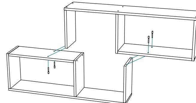
Подвески мебельные крепятся саморезами 4.0\*16 к торцам стенок вертикальных 1 и 2 крайних. Крепление к стене приобретается самостоятельно.
