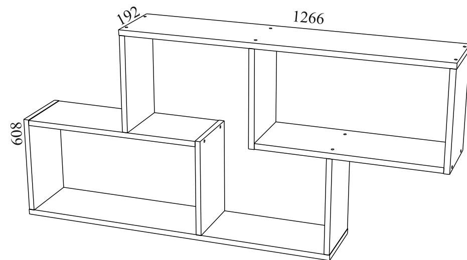
**Габаритные размеры: ширина - 1266 мм, высота - 608 мм, глубина - 192 мм.**
