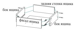
Задняя стенка ящика крепится к бокам ящика евровинтами. Фасад крепится к бокам ящика стяжками эксцентриковыми. Дно ящика вставляется в пазы и крепится держателями к бокам ящика и фасаду, к задней стенке ящика саморезами (3.0\*20).
