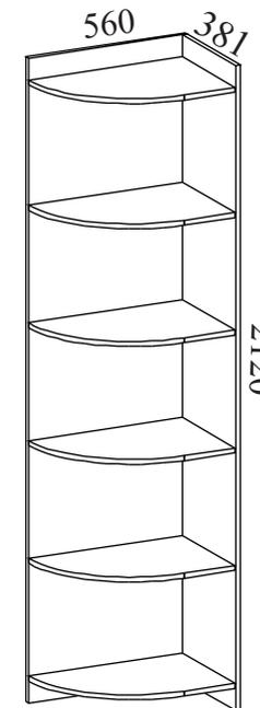
Габаритные размеры: длина - 560 мм, высота - 2120 мм, глубина - 381 мм.
