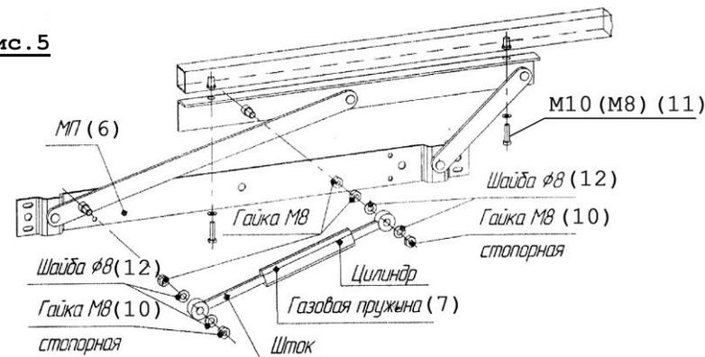
**Внимание!** Газовую Пружину устанавливать цилиндром вверх!
