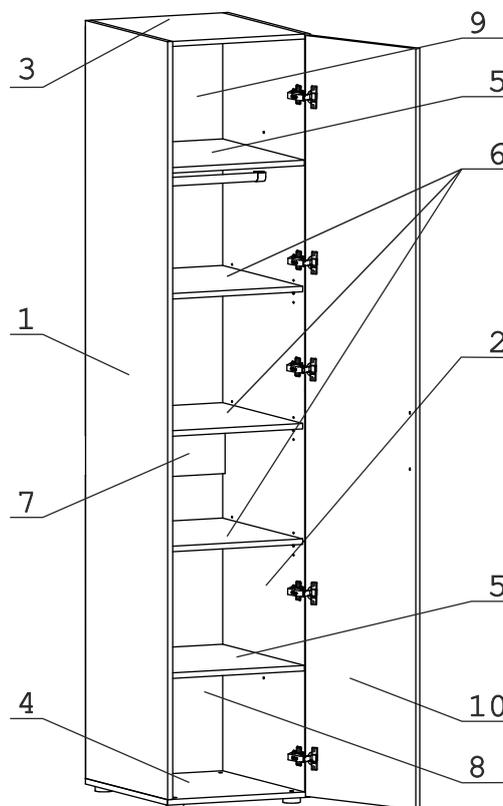
Для соединения нескольких шкафов между собой необходимо досверлить отверстия Ø6 с изнаночной стороны соседних боковин. Стянуть шкафы при помощи стяжек «О».
