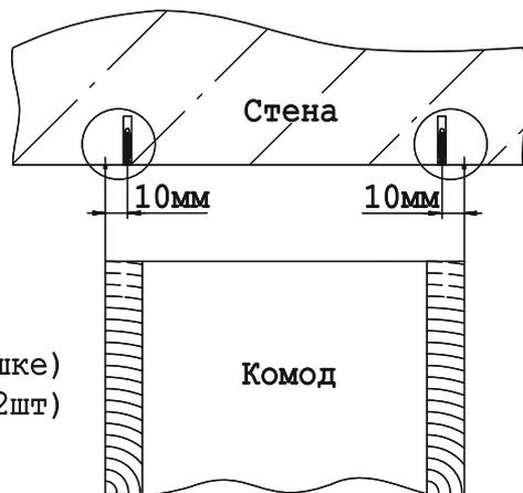
3. На боковины комода (как можно ближе к крышке) установить СКМ Рем 001 - Ремни безопасности (2шт) с помощью Шайбы М6 (2шт) и Шурупа 4x20 (2шт).
