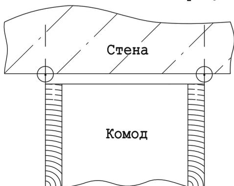
2. На расстоянии 10мм от ранее отмеченных точек просверлить в стене отверстия, установить Дюбель распорный 8x60 (2шт).
