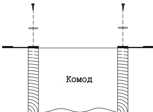
4. Сдвинуть комод в сторону от отверстий в стене приблизительно на 40 мм. Прикрепить СКМ Рем 001 к стене с помощью Шайбы М6 (1шт) и Шурупа 4,5x60 (1шт).
