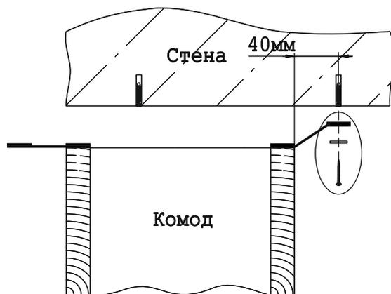
5. Сдвинуть комод в противоположную сторону приблизительно на 80 мм. Прикрепить СКМ Рем 001 к стене с помощью Шайбы М6 (1шт) и Шурупа 4,5x60 (1шт).
