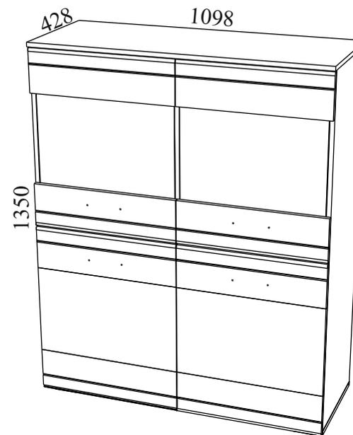
Габаритные размеры: длина - 1098 мм, высота - 1350 мм, глубина - 428 мм.
