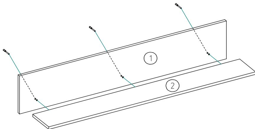
Схема сборки полки (рис.1)
