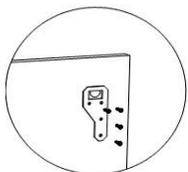
Схема крепления навесной пластины (рис.2)
