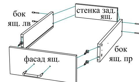
Стенка задняя ящика крепится к бокам ящика евровинтами, фасад ящика - стяжками эксцентриковыми.
