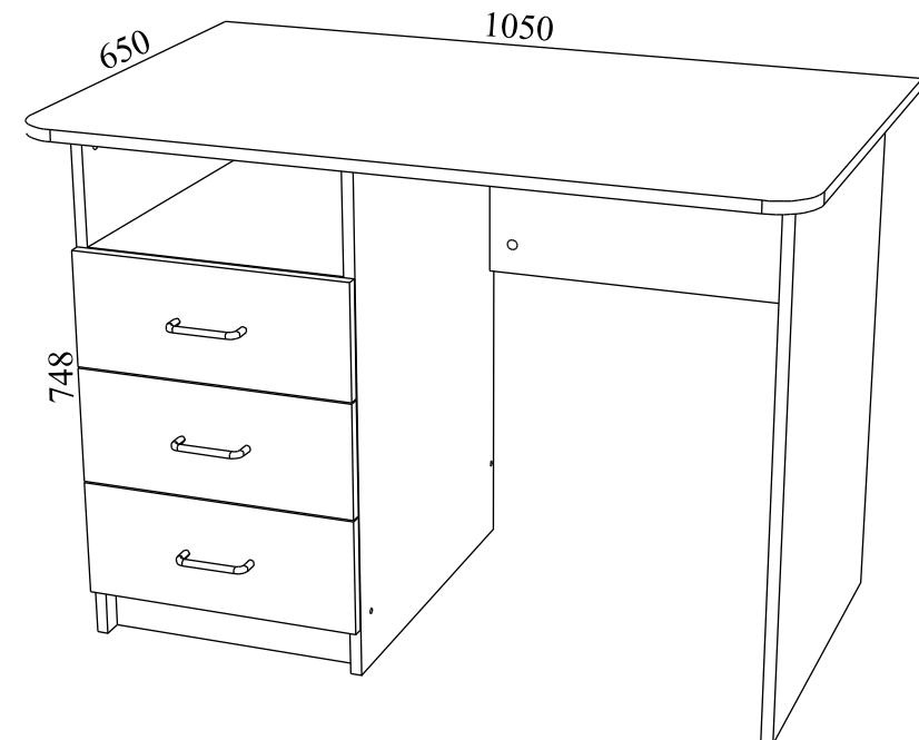
Габаритные размеры: длина - 1050 мм, высота - 748 мм, глубина - 650 мм.
