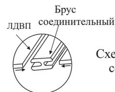
Схема крепления бруса соединительного
