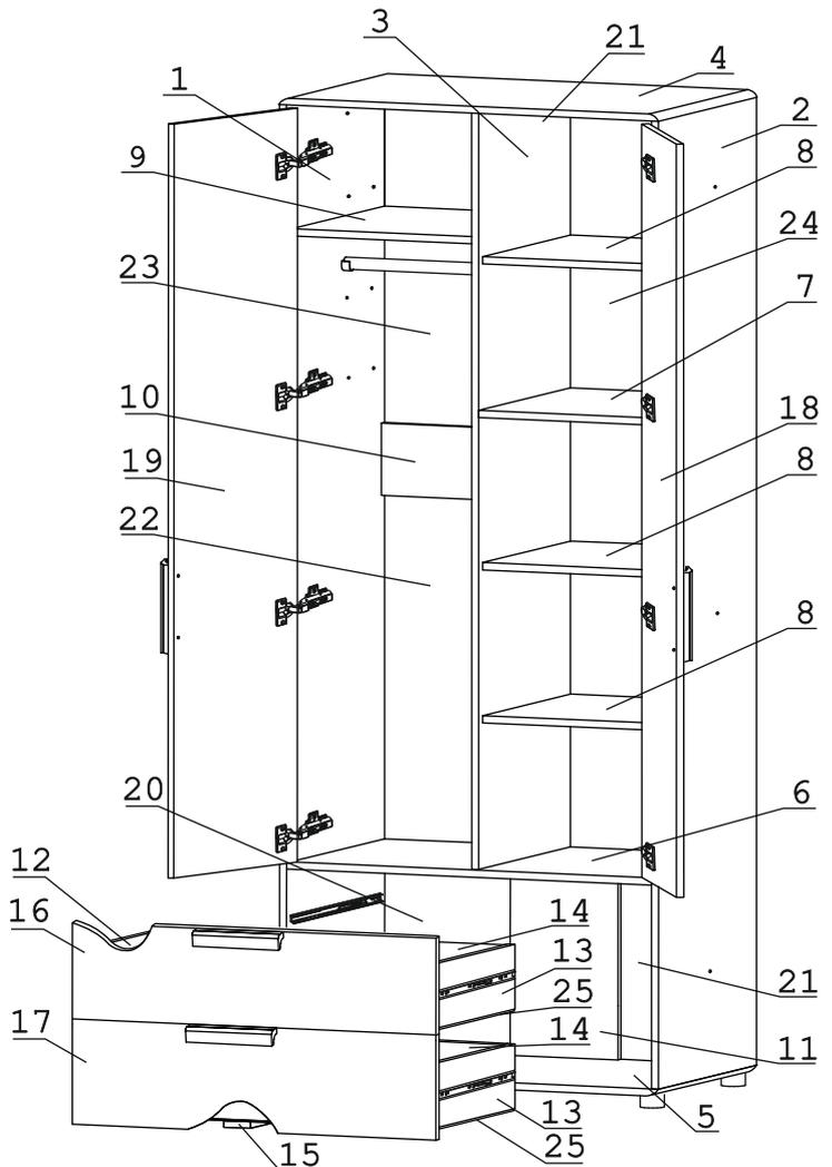
Перед началом сборки необходимо разъединить полновыкатные направляющие. Для этого максимально раздвинуть направляющую и нажать на пластиковый фиксатор. Далее выдвинуть внутреннюю часть из внешней.
