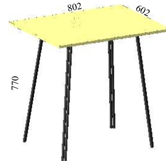
Габаритные размеры: длина - 802 мм, высота - 770 мм, глубина - 602 мм.
